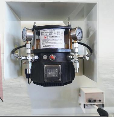
Rodillos de carga con lubricador automático.
