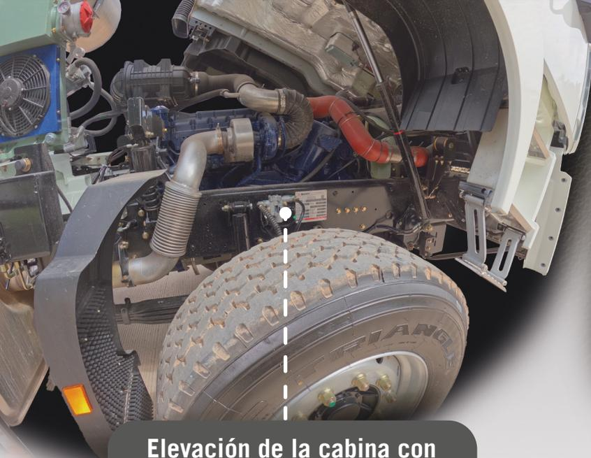
**Elevación de la cabina con motor eléctrico**
