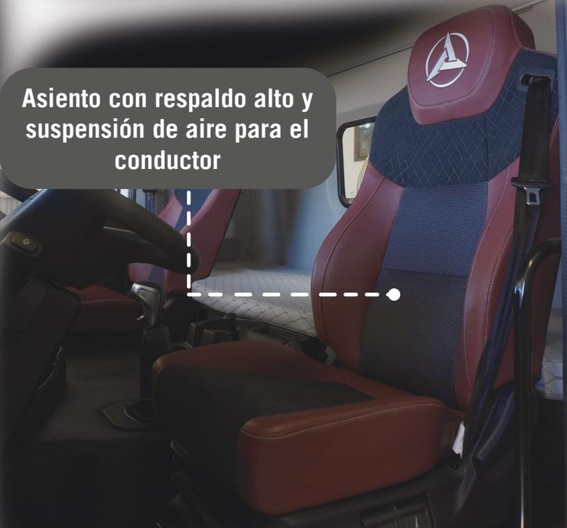
**Asiento con respaldo alto y suspensión de aire para el conductor**
