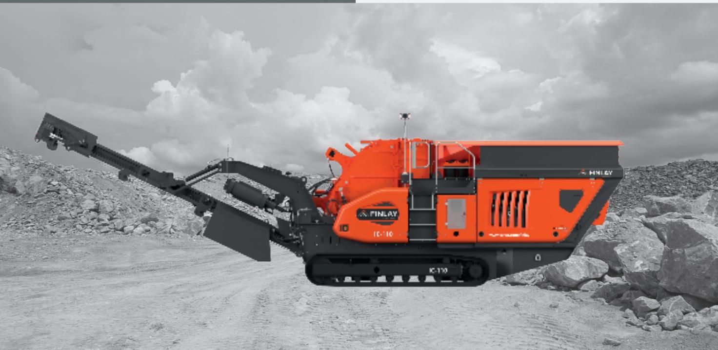
La trituradora de impacto compacta IC-110 ha sido diseñada para ofrecer alta productividad en aplicaciones de explotación de canteras, construcción y demolición de escombros, hormigón armado y reciclado de asfalto. La IC-110 cuenta con una cámara de impacto de accionamiento directo de Ø1034 x 1000 mm (Ø41,5" x 40") con velocidad del rotor variable y asistencia de ajuste hidráulico de la rampa para proporcionar un ajuste adecuado y eficiente de las rampas de la cámara.
