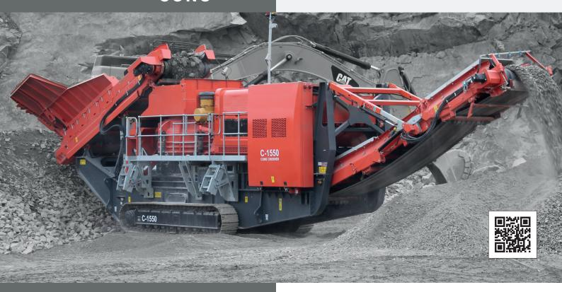
La Finlay® C-1550 es una potente trituradora de cono de gran capacidad para aplicaciones de minería superficial de mena y áridos. Esta máquina, eficiente y productiva, incorpora la probada trituradora de cono Terex® 1300 con transmisión variable directa mediante embrague, liberación automática de material atrapado y ajuste hidráulico del lado cerrado.
