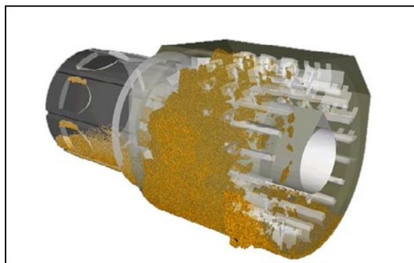
En el caso de aplicaciones con filler (cal hidratada o cemento) o fibra, los mismos pueden ser introducidos directamente en el mezclador, a través de una ventana lateral, o a través del anillo de reciclado.
