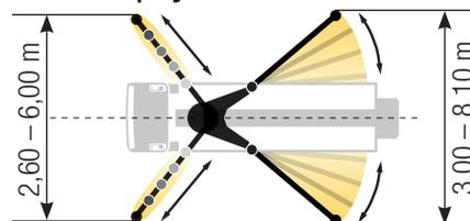
Las dimensiones dependen de la configuración. La anchura de apoyo se refiere al centro de la pata de soporte. Diámetro de la placa de soporte giratoria 270 mm.
